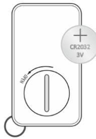
Wenn die Batterie gewechselt werden muss, verwenden Sie eine neue 3V CR2032-Batterie, um das Batteriefach zu öffnen. Nehmen Sie die leere Batterie heraus und legen Sie die neue Batterie mit dem „+“ nach oben in die Fernbedienung ein. Verwenden Sie die leere Batterie, um den Deckel wieder zu schließen..
